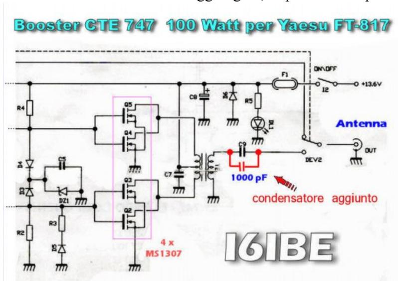
Allego anche parte del **layout**, relativo alla disposizione dei componenti vi permette una facile e veloce individuazione di C9, saldate in parallelo a questo, uno da **1000 pF**, rimuovete momentaneamente il fusibile per comodità di manovra durante la saldatura, ricordandovi però, di risistemarlo nel suo alloggiamento prima di richiudere il coperchio.
