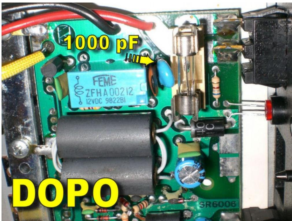
La capacità totale risulterà essere di 1100 pF sufficiente per permettere di lavorare in tutta tranquillità anche sulle gamme 3,5 e 7 Mhz. Lo strumento infatti ora segna **80 Watt RF** ,
