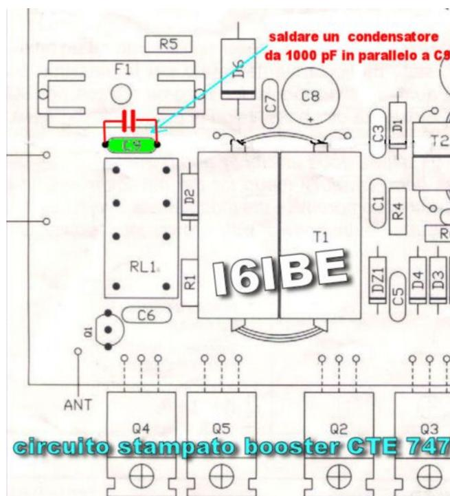
Questo economicissimo amplificatore e' in grado di fornire una potenza di circa **100 watt**, occorre quindi un alimentatore in grado di erogare almeno **20 Ampere**. Il montaggio è ben curato e non si notano rientri RF, eventualmente montate un **choke RFI** sui fili di alimentazione, una ferrite a crimpare o un toroide su cui avvolgere qualche spira, questo aiuterà senz'altro a risolvere il problema dei rientri RF o inneschi se eventualmente ce ne fossero.
