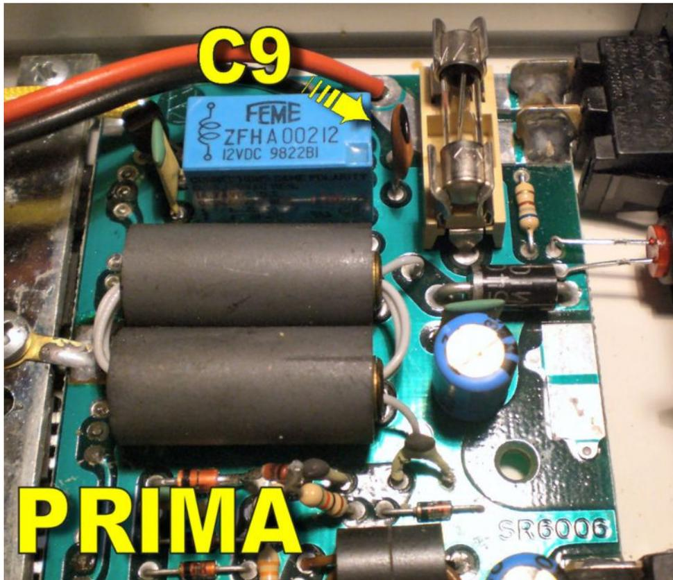
Nelle foto vedete lo stampato prima e dopo la modifica, il condensatore “blu” è stato aggiunto e saldandolo in parallelo a quello esistente (C9).
