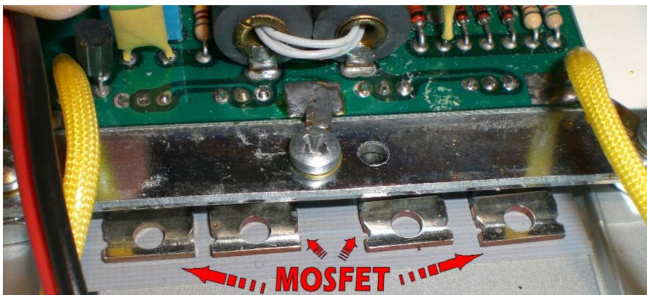
Questi sono i 4 Mosfet di potenza montati in parallelo ed in grado di erogare un centinaio di Watt se pilotati con potenze di 5-10 Watt in ingresso. Il circuito è in configurazione **PUSH-PULL**, con
